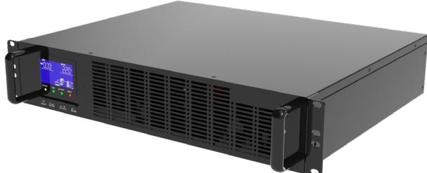
R 系列锂电 UPS(1~3kVA) 基于在线双变换技术，为小型场景的理想供电解决方案，可全面消除各类电网问题，支持机架式安装，效率最高可达 96%。机型小巧，功率密度高，配合 R 系列锂电池备电，有效节省安装空间。支持来电自启动，适应无人值守站点。选配多种智能卡，全面灵活监控 UPS 状态。
